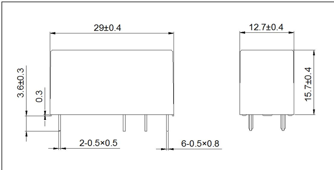
备注：外形图中产品部分未注公差尺寸，当尺寸 $\leq 1\text{mm}$ ，公差为 $\pm 0.2\text{mm}$ ；
